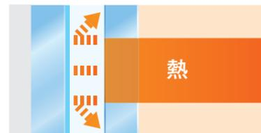
物体から発生する熱エネルギーが他の物体へ移動する「放射」。Low-E膜が放射をおさえます。
